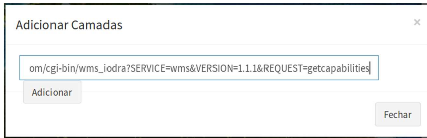
Figura 6.4 – Módulo de Monitoramento - Adição de camadas externas em WMS.
